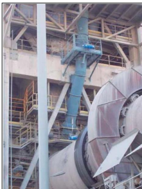
Figura 10: Conducto de entrada de neumáticos al horno.
